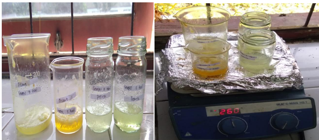
Gambar 3. Destruksi Sampel dengan Metode Destruksi Basah dan Pemanasan Sampel dengan Hot Plate
